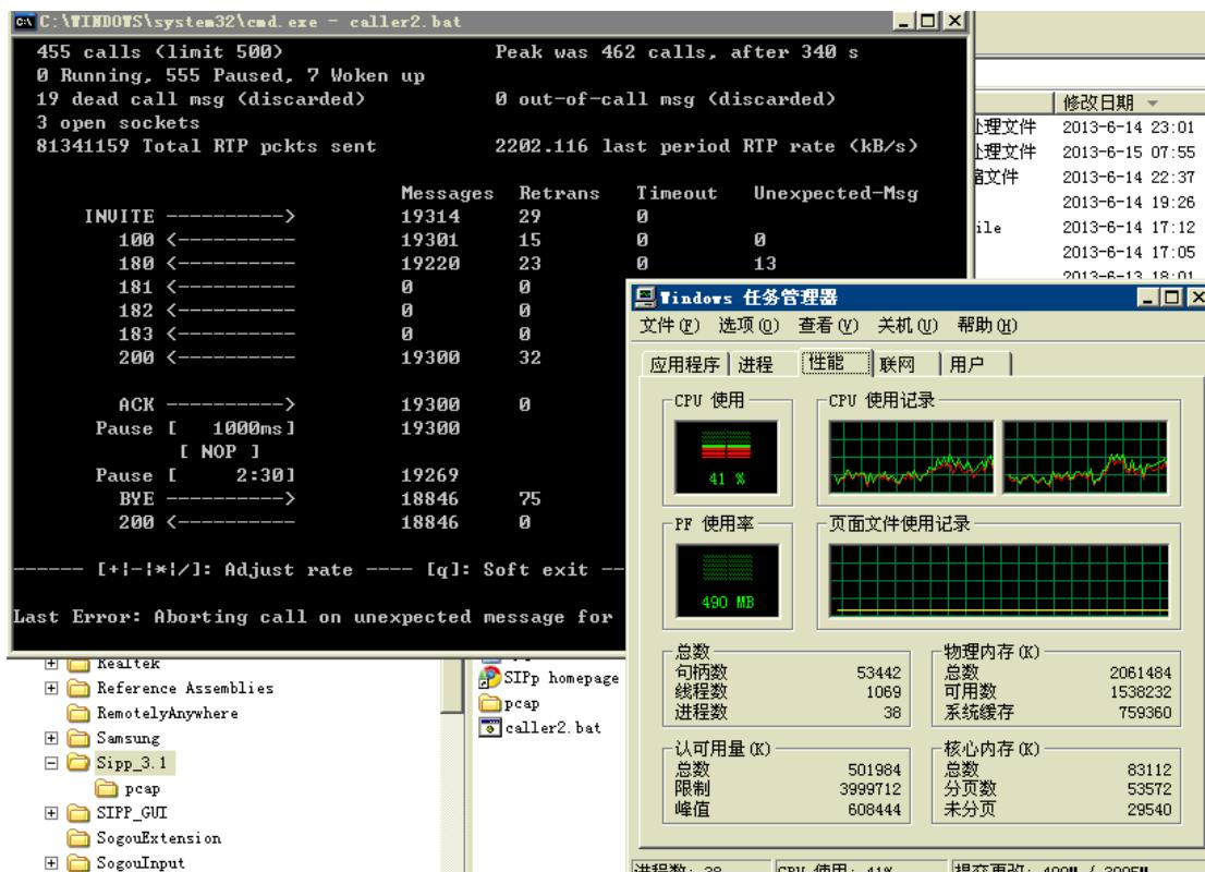
压力测试，FreeSwitch 运行在 E5-2640cpu\*2，16G 内存配置的机器，通话没有录音的模式下：
