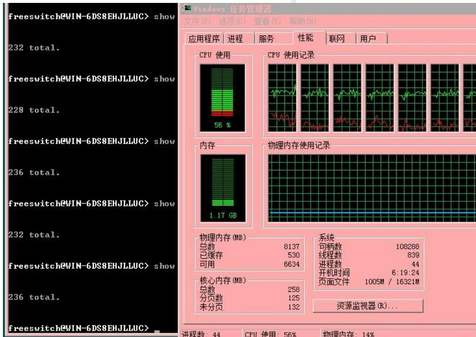
对比上面测试场景 2 发现语音转码的 CPU 开销还是很大的：线路少了一半，cpu 开销几乎多了一倍，换句话说转码的 cpu 开销是没有转码的 cpu 开销的差不多 3-4 倍。
