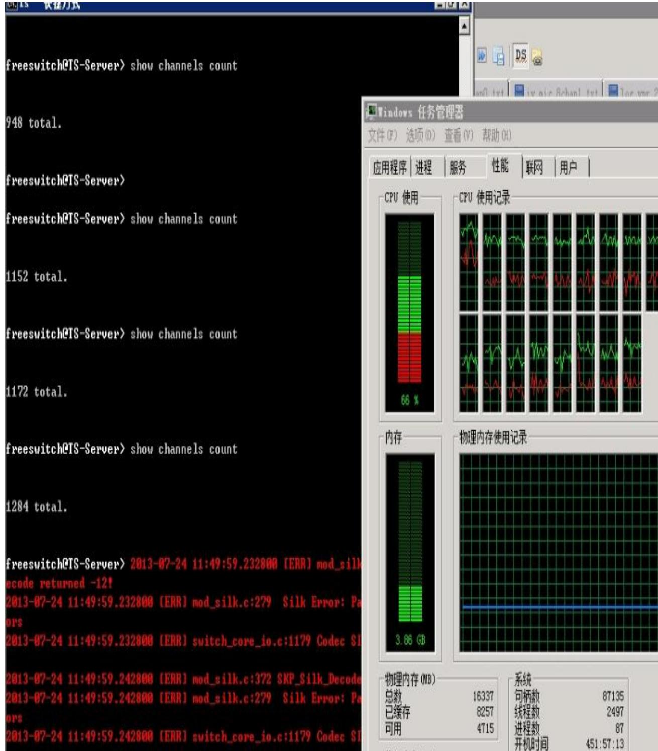
保守估计使用 SILK 的转码通话这个配置两个 E5-2640CPU 的机器大约支持 1000 线并发。
