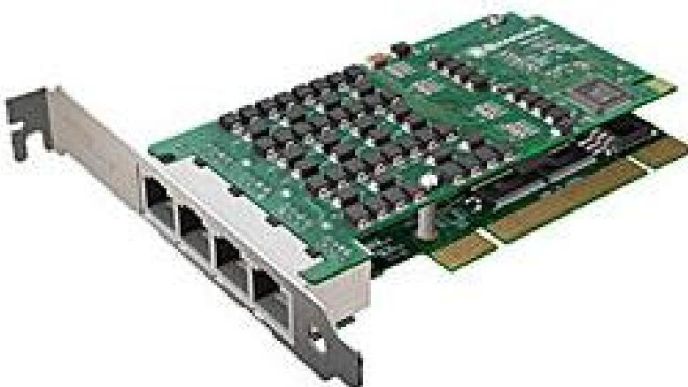
下图是 PCI-E 插口的 8E1 的接口 E1 卡,跟上面的对比区别在于支持的插槽不一样。
