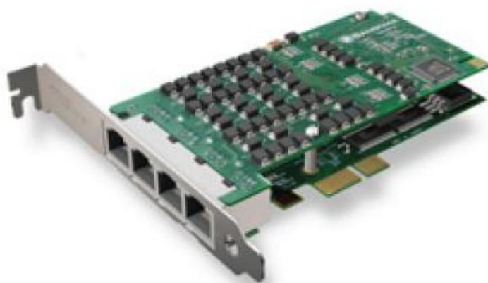
下图是 PCI-E 插口的 16 E1 的接口 E1 卡
