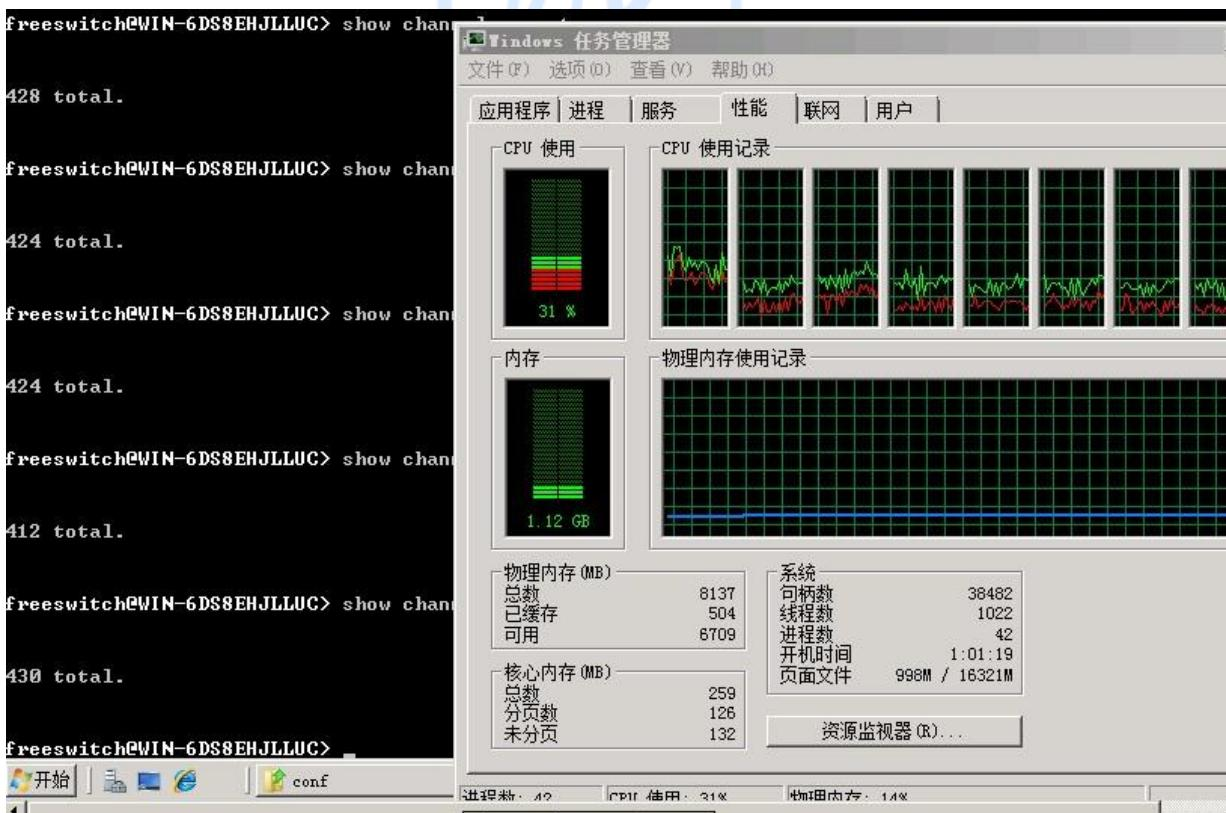
测试运行接近 10 个小时，通话 87712 次，然后停止测试，发现 FreeSwitch 存在句柄泄漏，如下图，句柄占用达到了 177,999 个（难道拨入转出的呼叫由于有两个 channels，因此每次呼叫泄漏 2 个？）。
