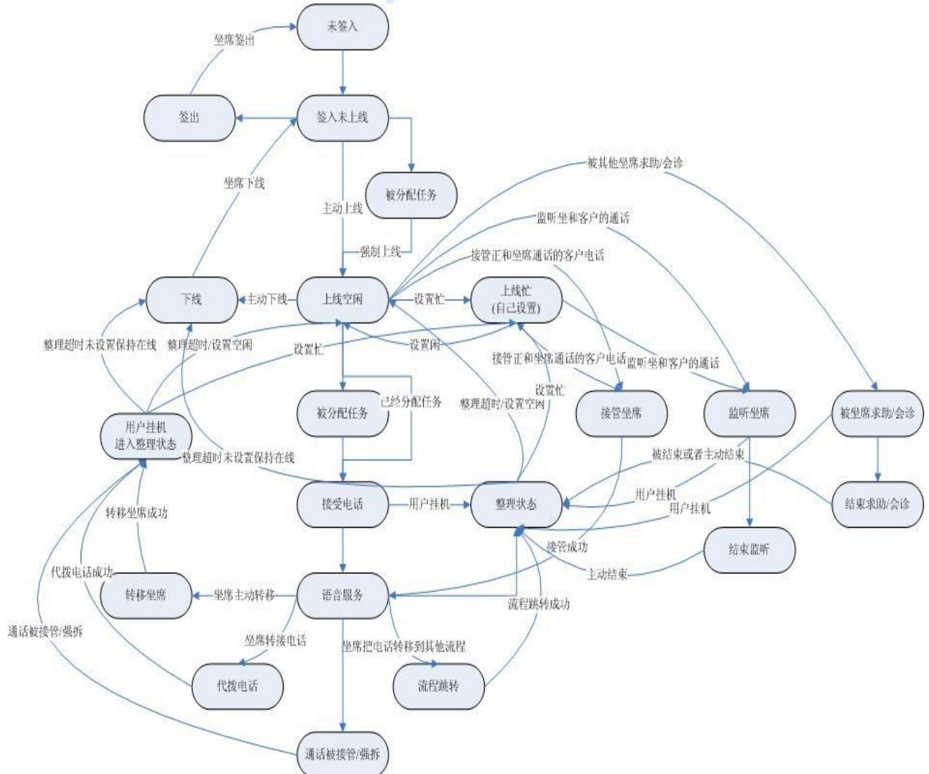
这个有限状态机就比较复杂.实际编程实现过程,使用异步模式编程,加上用户的拨入拨出控制,整个呼叫中心用户拨入,呼叫用户和坐席控制代码量达到了 528KB.
